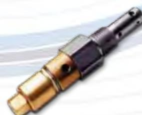
**DETECTOR MECÁNICO DE FUGAS:** Cuando una fuga ataca químicamente a una junta tórica de este detector, acciona un émbolo. Esto abre una válvula de aire que, a su vez, activa un solenoide (o un dispositivo similar) suministrado por el cliente para generar una señal.
