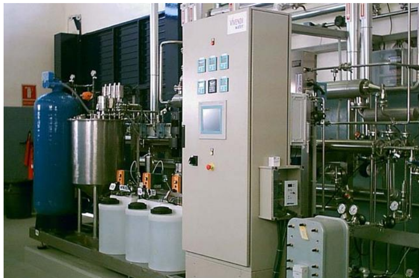
Foto 2. Vista de un sistema de producción de agua purificada basado en ósmosis inversa y electrodesionización en continuo (producción 24 m 3 /día)
