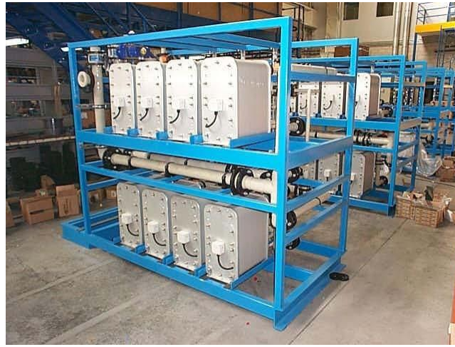
Foto 1. Vista de un sistema modular de electrodesionización en continuo
