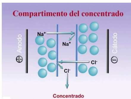
Imagen 2. Migración de los iones en el concentrado.
