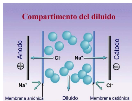
Imagen 3. Migración de los iones en el diluido.
